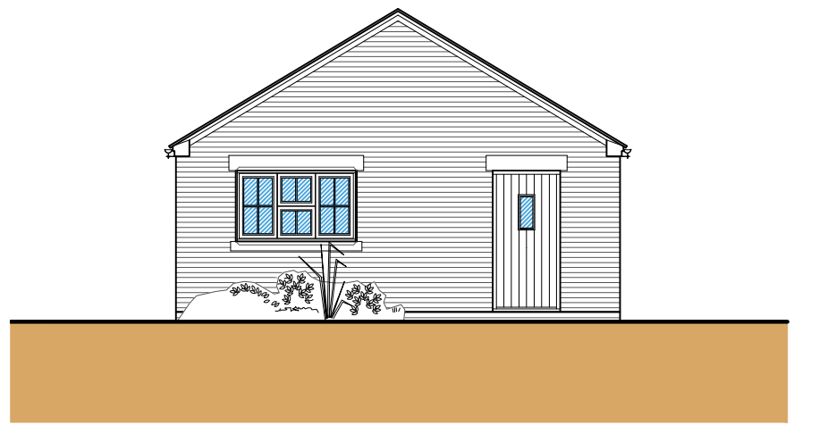
Rear Elevation Scale: 1:100
